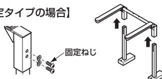
本体フレームの裏側にある固定ねじ(左右2本ずつ)を外し、アームレストを上を持ち上げ取り外します。
